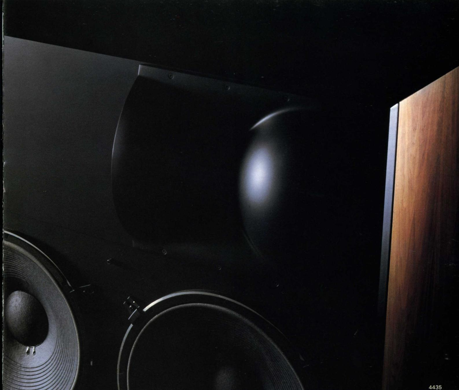
化を達成し、4ウェイにも劣らない広帯域特性で2ウェイならではの長所を鮮烈に拡大しています。じつにバイ・ラジアルホーンは、水平・垂直方向とも100°の定指向性を可聴帯域の上限まで保ち、音場再現や音像定位の決め手となる放射エネルギーのフラットネスを厳密に確保しています。また、ホーンでありながらドライバーとウーファーの振動板位置を同一面に設定できることで、理想に近いタイムドメイン特性を獲得しています。これによって4435/4430は、見えるようにクリアな音像と、4ウェイのように緻密な広帯域レスポンスをシンプルな2ウェイ構成で実現したのです。より大型で低域特性とパワーハンドリングにすぐれた4435は、通常のダブル・ウーファー方式とは違ってエンクロージャーに仕切りがあります。1本の使用帯域を100Hz以下に限定することで位相干渉を防ぎ、バイ・ラジアルホーンと同様な定指向性をもたせ
