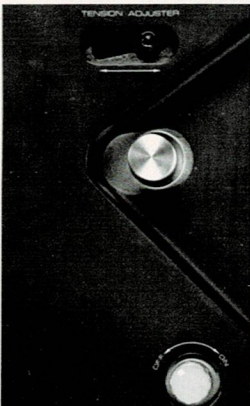
▲RY-1500Dのプーリーは糸・ベルト兼用。太鼓面中央の溝に糸をかける仕組みである
