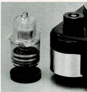
▲空気とオイルの粘性抵抗、さらに特殊形状のゴム、円錐状の金属スプリングを巧みに組み合わせた新開発のサスペンション。高い支点をもち、減衰特性に特に優れる
